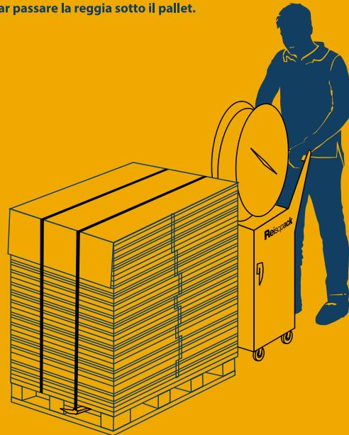
La macchina si avvicina manualmente al pallet, evitando di spostare il carico prima della reggiatura.
